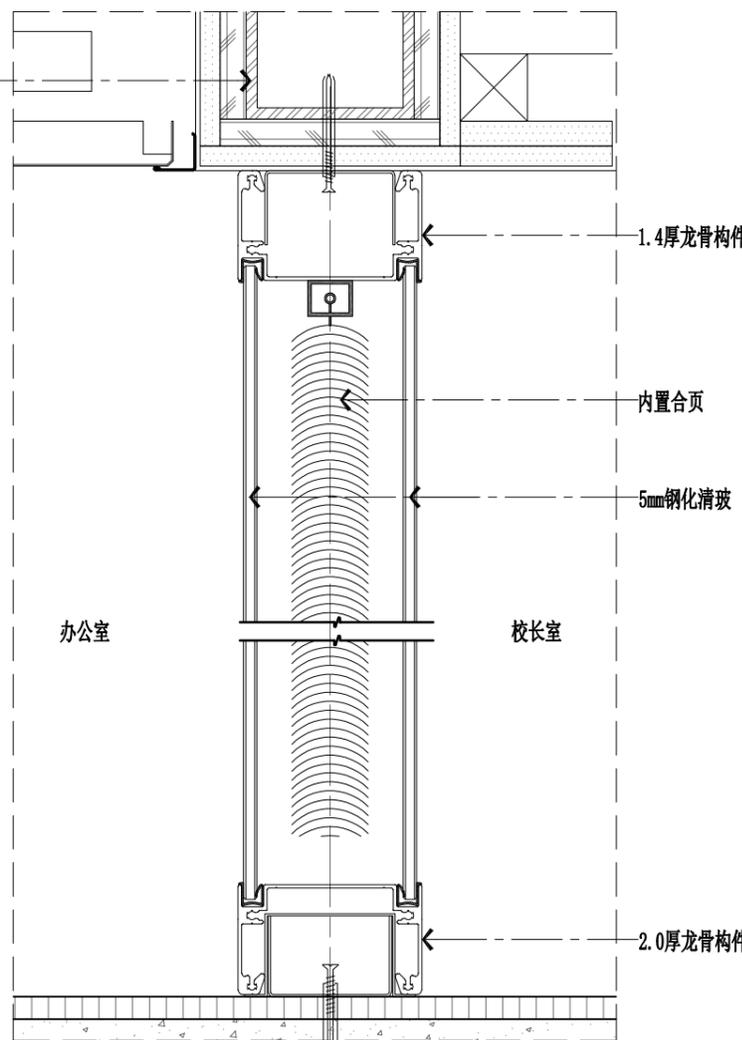
**01** 双玻百叶隔断立面图 SCALE 1: 40
